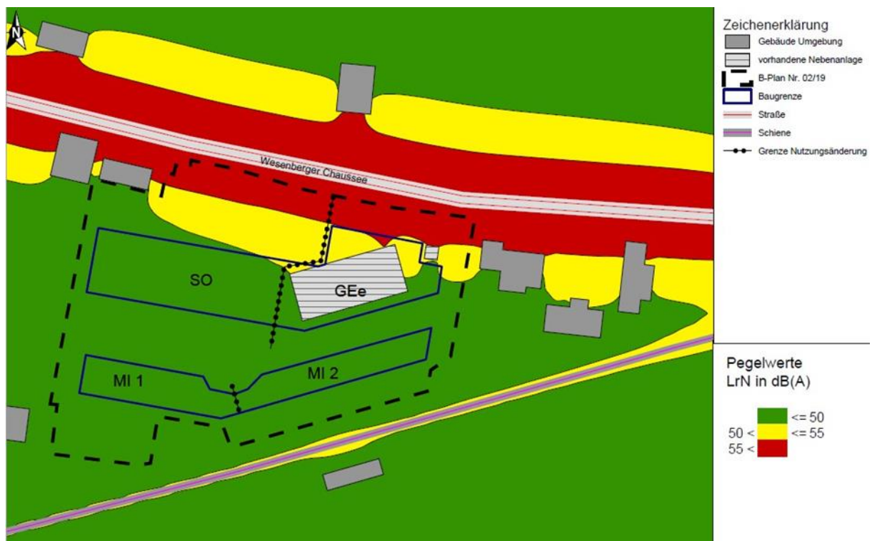
Abbildung 3; Isophonenkarte in 5 m über Gelände, nachts 22:00 bis 06:00 Uhr (Schallschutzgutachten Hoffmann Leichter 2022)
