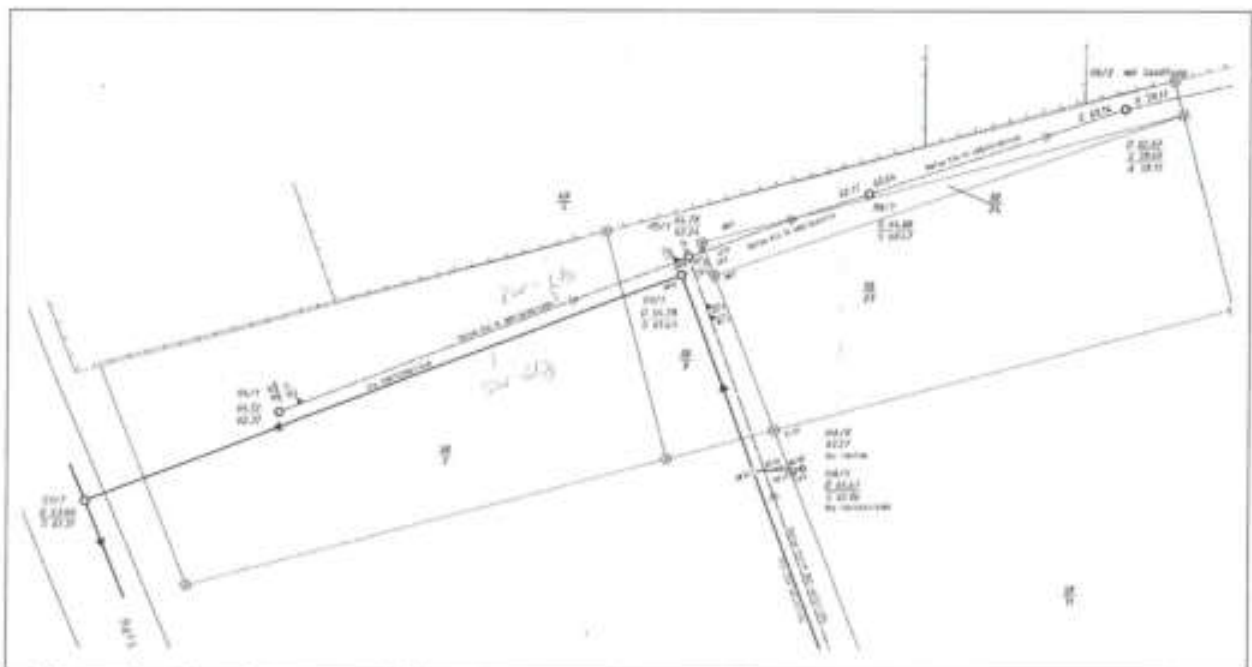
Abb.: vorhandene Regen- und Schmutzwasseranlagen
